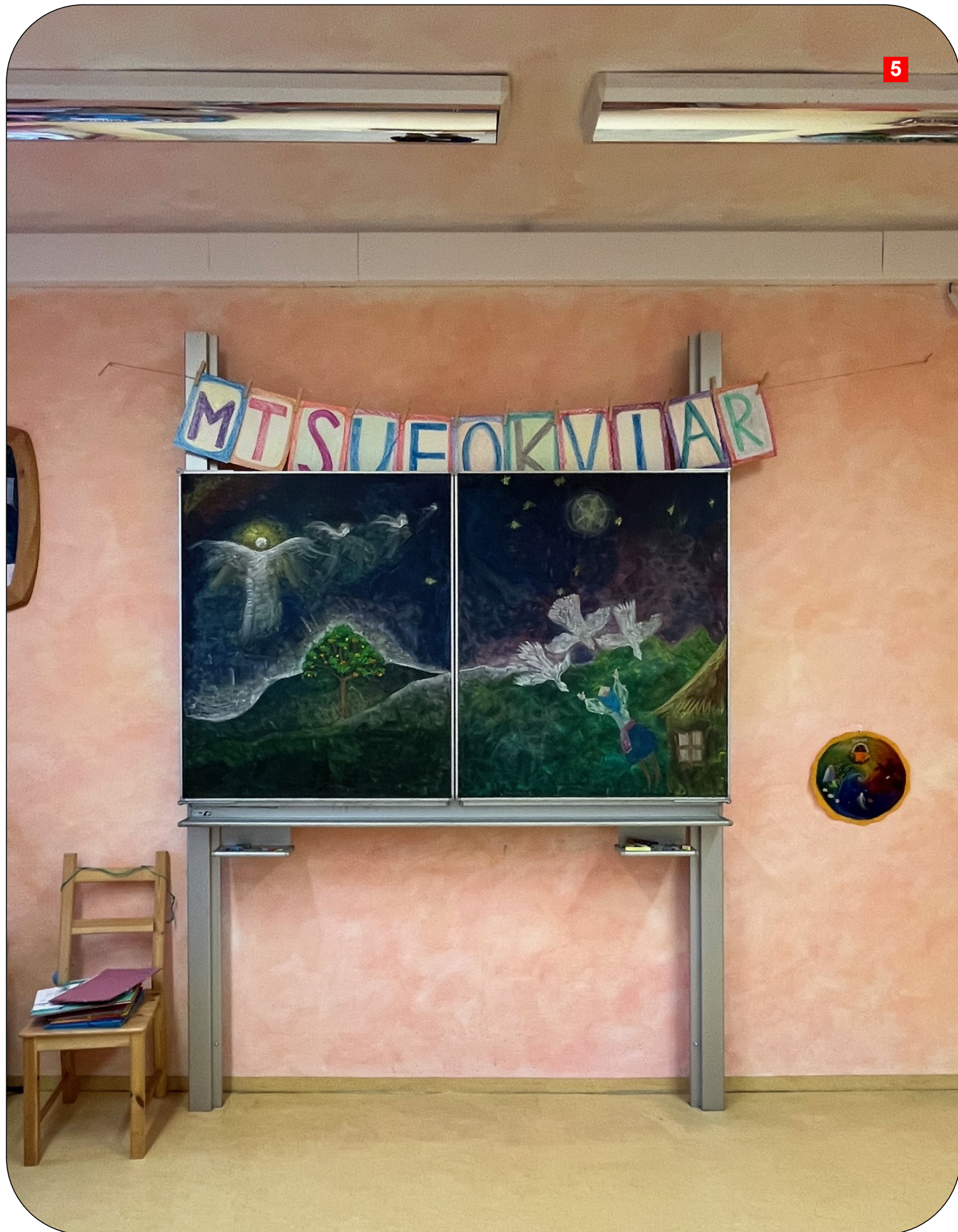
ŠKOLNÍ OTVÍRACÍ TABULE DUBNO - POSUVNÁ NA PILONECH S PROTIZÁVAŽÍM, OTVÍRAVÁ, ČERNÁ, ZAVŘENÝ ROZMĚR TABULE š. 2000 / v. 1 200, OTEVŘENÝ ROZMĚR TABULE š. 4 000 / v. 1 200 mm, DOLNÍ PRŮBĚŽNÁ LIŠTA NA CELOU ŠÍŘKU TABULE NA ODKLÁDÁNÍ KŘÍD A PROTI STÉKÁNÍ VODY. V PŘÍPADĚ VYUŽITÍ JINÉHO VÝROBCE A TYPU NEŽ DUBNO, JE NUTNÉ POTVRZENÍ KVALITY PŘED OBJEDNÁNÍM OD AD.
