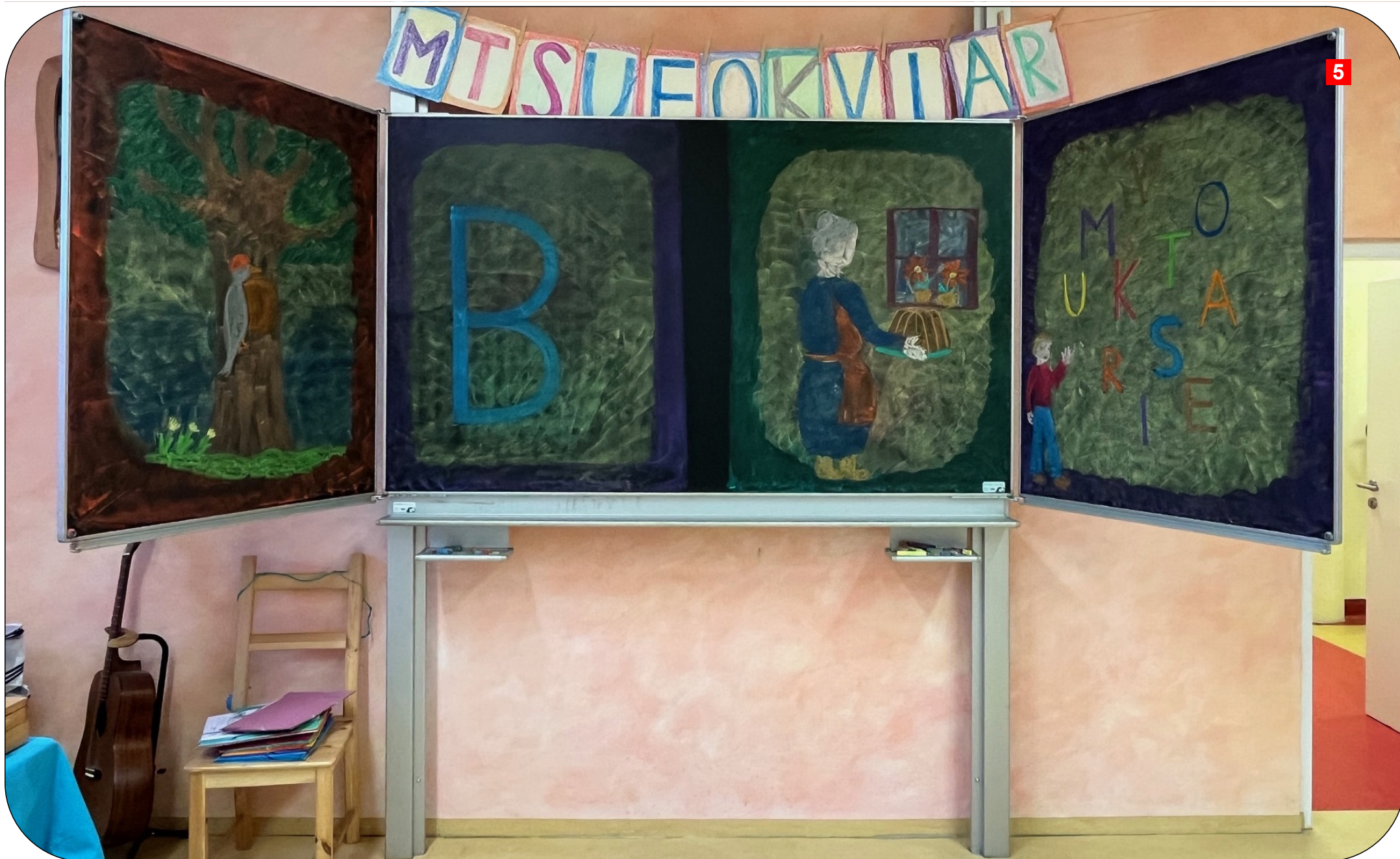
ŠKOLNÍ OTVÍRACÍ TABULE DUBNO - POSUVNÁ NA PILONECH S PROTIZÁVAŽÍM, OTVÍRAVÁ, ČERNÁ, ZAVŘENÝ ROZMĚR TABULE š. 2000 / v. 1 200, OTEVŘENÝ ROZMĚR TABULE š. 4 000 / v. 1 200 mm, DOLNÍ PRŮBĚŽNÁ LIŠTA NA CELOU ŠÍŘKU TABULE NA ODKLÁDÁNÍ KŘÍD A PROTI STÉKÁNÍ VODY. V PŘÍPADĚ VYUŽITÍ JINÉHO VÝROBCE A TYPU NEŽ DUBNO, JE NUTNÉ POTVRZENÍ KVALITY PŘED OBJEDNÁNÍM OD AD.
